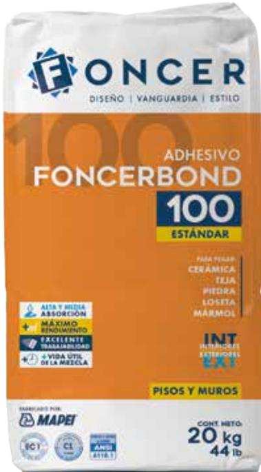
**Foncerbond 100** es un adhesivo cementicio, con arena fina de granulometría controlada, resinas y aditivos especiales; para la instalación de piezas cerámicas de alta absorción sobre sustratos absorbentes, en pisos y muros, en áreas interiores y exteriores de uso residencial.
